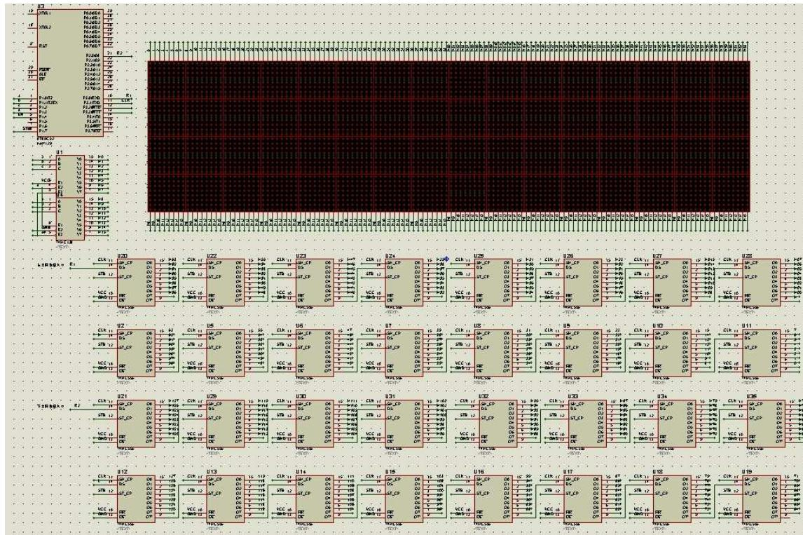
这是一个完整的 128\*32 的点阵屏，只是在上面小屏的基础上级联了更多的 595，因为只有一个 4 选 16 的译码器，而该点阵有 32 行，这里我们使用两个数据输入端，分别对应点阵屏的上、下半屏。下面以操作上半屏为例（下半屏同理）。
