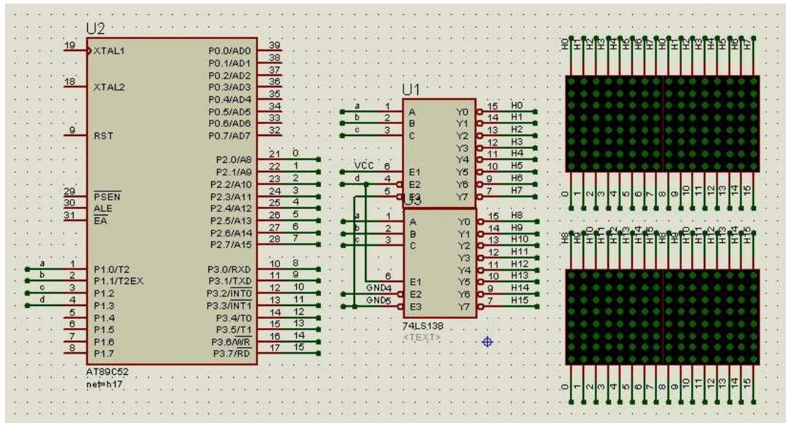
3.连好线后，P1 作为行选，P2、P3 一起作为列选。现在 16\*16 的点阵被分成两块并不完整的部分，我们可以整体移动（包括点阵屏、连线以及连接点，）来方便我们观察显示的效果（最好同时去掉仿真中电平的指示灯）。接着我们来看一个程序，还是让此点阵屏显示
