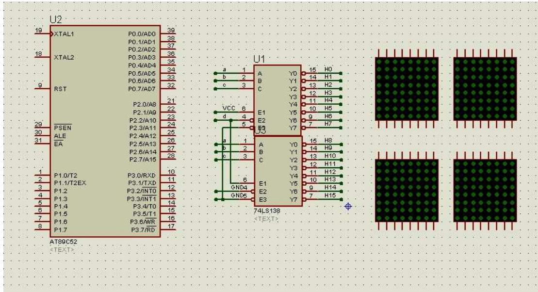
2.先来看看 4 选 16 的译码器是如何工作的，这里有 4 个输入端 a、b、c、d，16 个输出端 H0~H15 ,如上图连线后即可完成类似于 38 译码器一样的工作。只不过扩展到了 16 行选。关于连线的原理这里不再赘述，只要明白 38 译码器的原理这个可以轻松理解。接着完成全部布线。如下图所示：
