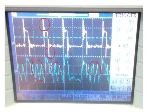
补充: 3.3V 原波形的上下冲很严重 怎么解决(波形由 FPGA 直接输出)
