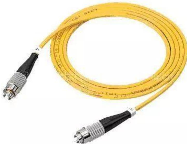
该图为 FC/PC 型光纤跳纤（非正规叫法是双头尾纤），英文名为 PATCH CORD 即两头带光纤连接器的软光纤，用于设备至 ODF 架的连接以及 ODF 架之间的跳接。光跳线颜色为黄色，表示单模跳纤。
