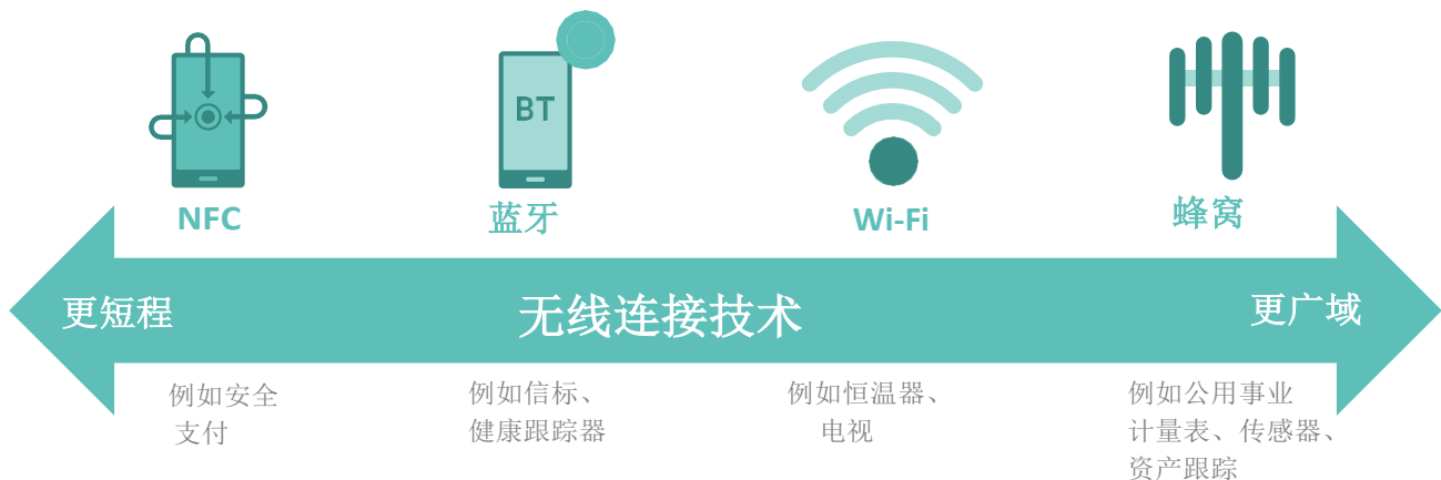
图1：物联网无线连接技术范例
