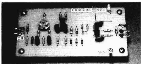
照片 5.3 完成后的 7 管高速宽带 放大器的电路板
