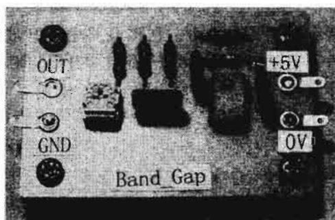
照片 5.13 完成后的带隙型稳压电路
