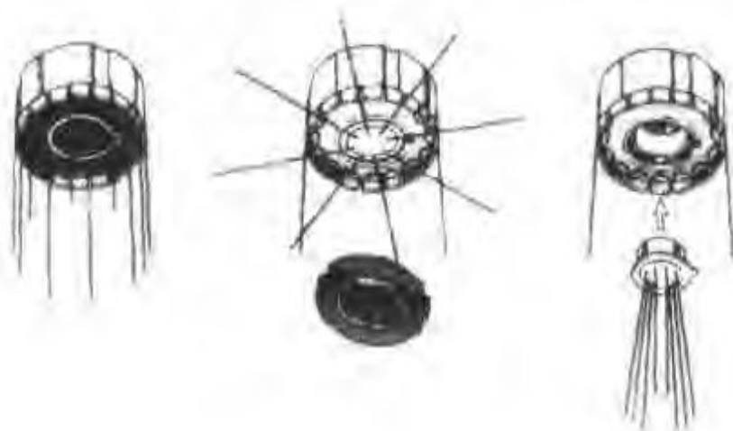
图 2.14 IC 用简易恒温槽
