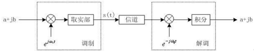
发送端：输入 $a+jb$ （I路输入 $a$ ，Q路输入 $b$ ）。
